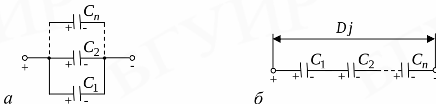
Рис. 12.19. Соединения конденсаторов: а – параллельное; б – последовательное
